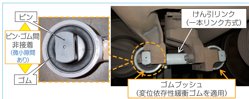
図2 変位依存性緩衝ゴムと一本リンクへの取付状況
