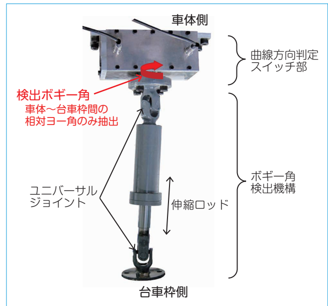
図7 逆・直線操舵防止機構
