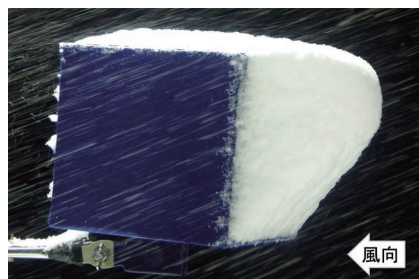
図7 実験(立方体モデル)の着雪形状
