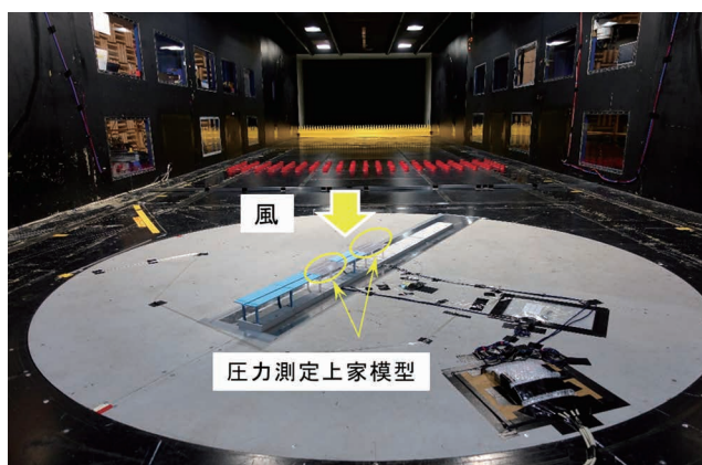
図 風洞試験の様子【風向角150度の条件】
