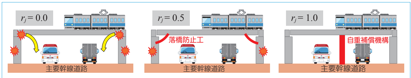
図3 主要幹線道路の封鎖の観点からの周辺空間の確保性 r_j
