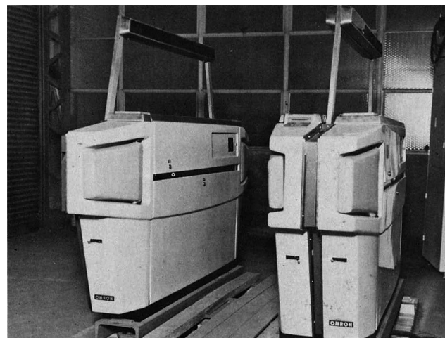
図3 鉄道技研で開発された自動改札機
