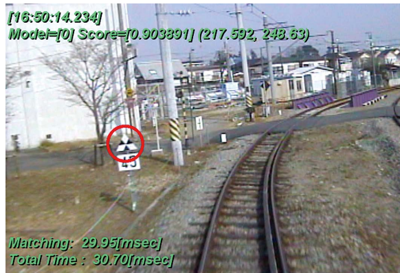
図5 走行試験の結果(鉄道総研所内試験線)
