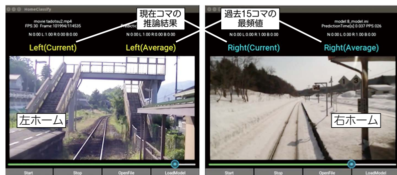
図4 深層学習を用いた画像によるホーム検知結果
