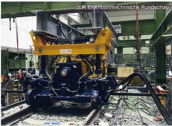
出典:Eisenbahntechnische Rundschau ミュンヘン工科大学におけるダイナミック・スタビライザーの試験
