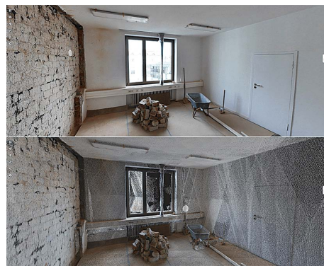
図2 LiDARセンサーにより測定した部屋(上)と点群データ(下) (提供：構造計画研究所)
