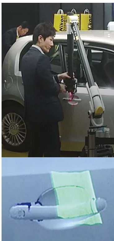
図3 アーム式3Dスキャナーを用いて測定している様子(上)と得られた点群データ(下) (提供：ニコンインステック)
