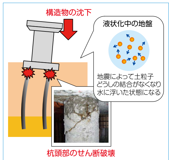
図1 液状化による基礎構造物の被害
