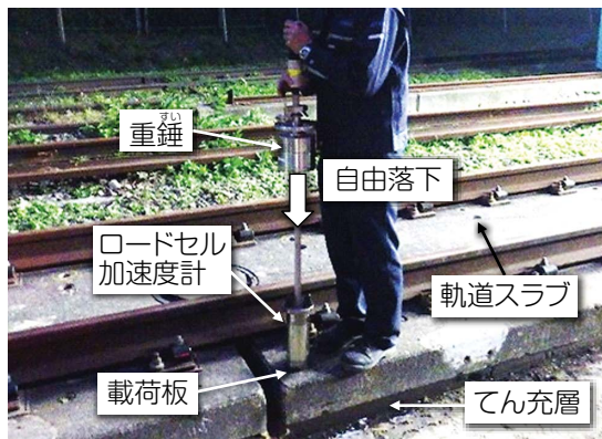
図4 軌道スラブ上面における小型FWDを用いた重錘落下試験
