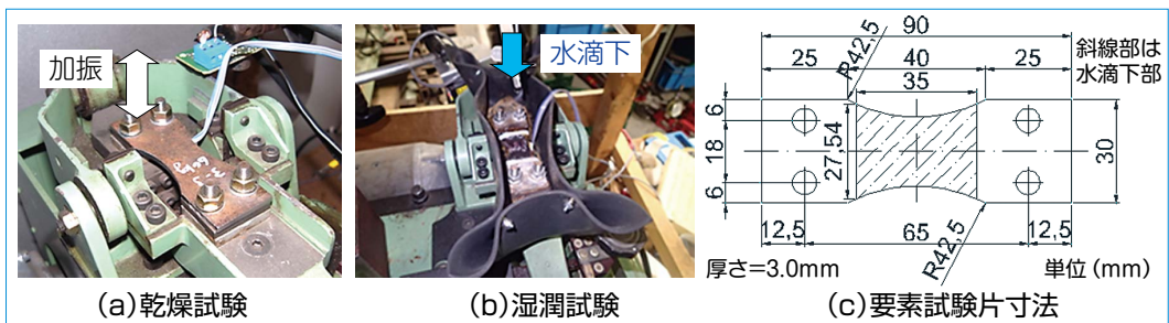
図8 要素試験片の平面曲げ疲労試験
