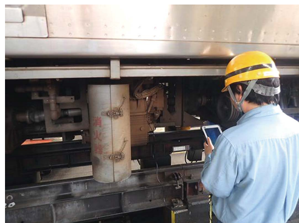
図2 タブレット端末による振動測定
