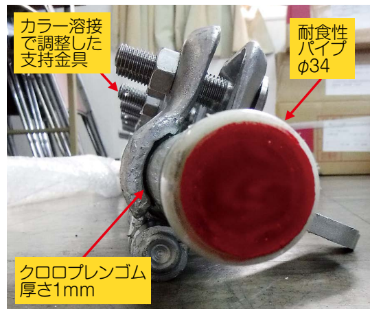
図2 開発した耐食性パイプと支持金具
