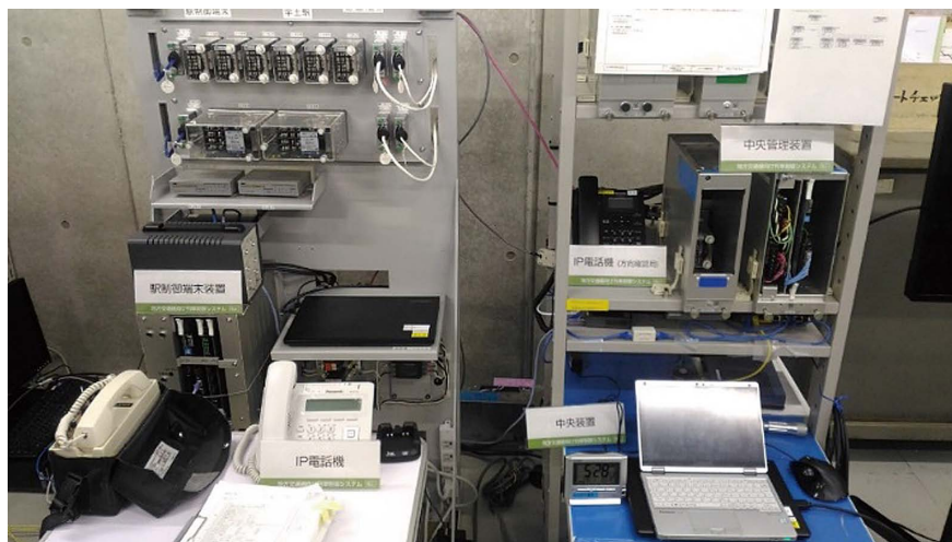
図3 駅制御端末と中央管理装置
