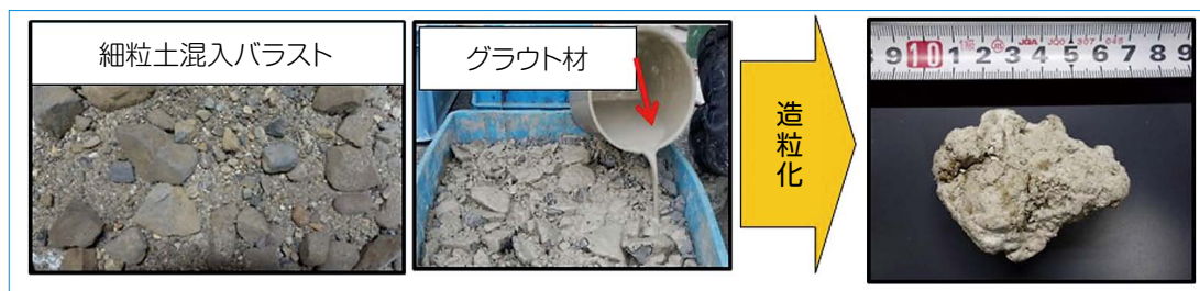
図7 造粒化工法によるバラストの機能回復
