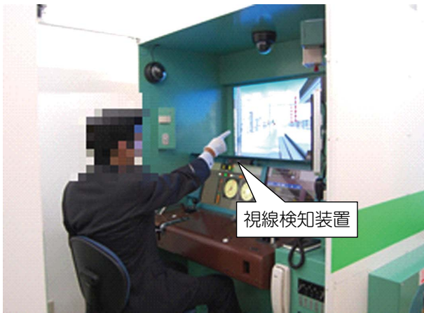
図1 視線検知装置付き運転シミュレーター
