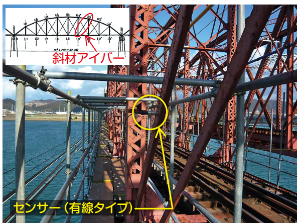
図1 斜材アイバーの固有振動数計測
