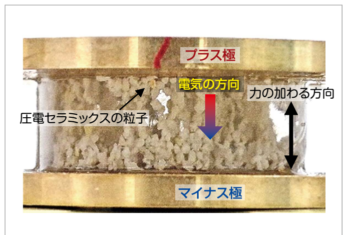
図2 ゴム材中で接触、配列した圧電セラミックスの粒子
