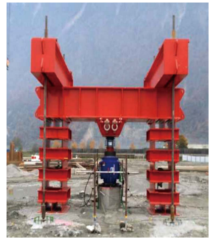
図6 フランスでの杭の鉛直載荷試験の様子
