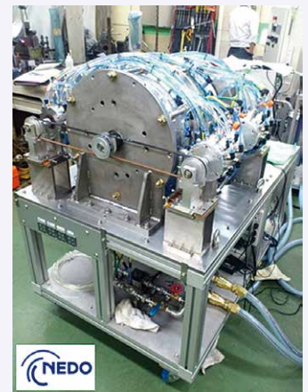
図9 1.4kW磁気ヒートポンプ試作機
