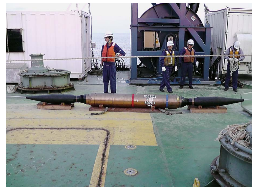
図3 S-net海底地震計 観測装置 (提供：防災科学技術研究所)
