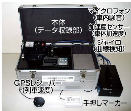
図5 レール波状摩耗モニタリング装置の外観
