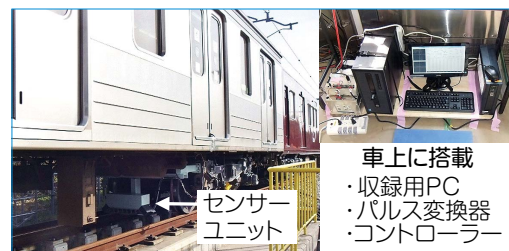
図13 旅客用車両の走行試験の様子
