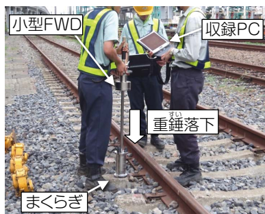
図2 軌道支持剛性の測定状況の例
