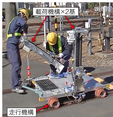
図9 RFWDの組み立て状況
