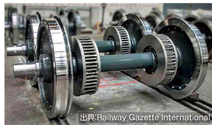
出典: Railway Gazette International 車軸表面がコーティングされた、ブレーキディスク付き輪軸
