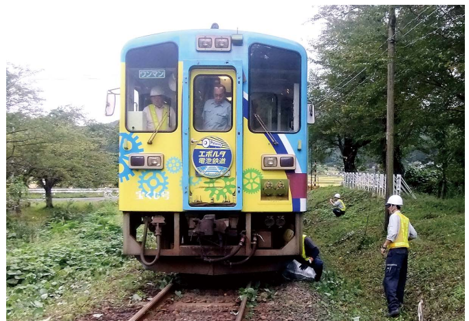
現地調査の風景（急勾配箇所での列車発進試験）
