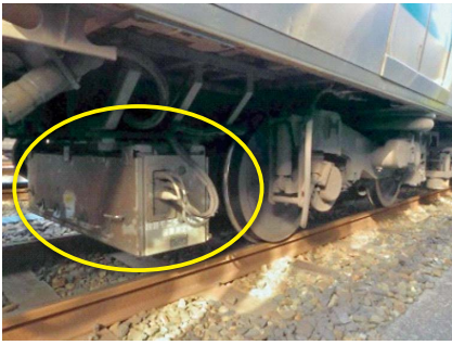
図10 営業車に搭載された慣性正交軌道検測装置
