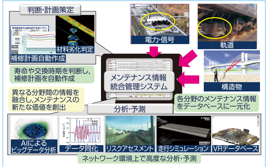
図12 ICTを活用したメンテナンス情報の統合管理のイメージ
