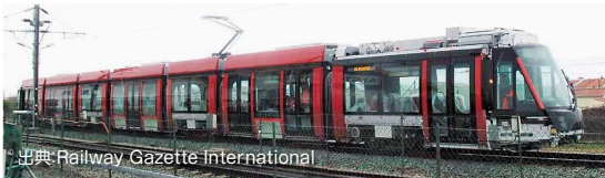
アルストムのラ・ロシェル工場で試験が続けられているニースの2号線向けのCitadis405
