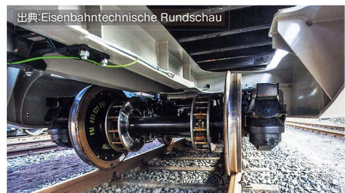
防音リングとディスクブレーキを装備した軸輪
