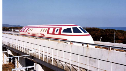
図8 MLU001 2両連結での走行実験
