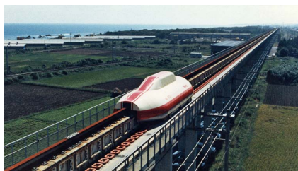
図1 ML-500による走行実験
