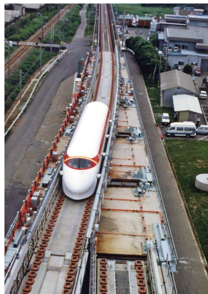
図11 MLU002 分岐側線進入試験
