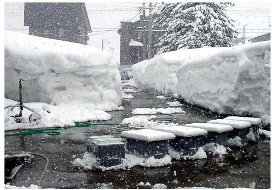
図3 実験スペースでの試験状況(散水時の雪の変質調査)
