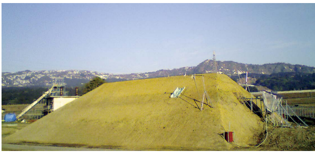
図5 斜面積雪・融雪実験盛土
