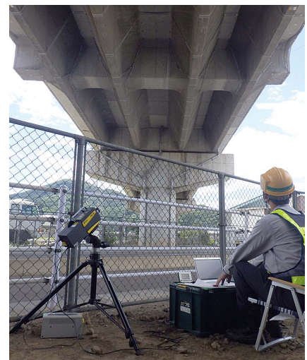
図2 UドップラーIIによる計測の様子
