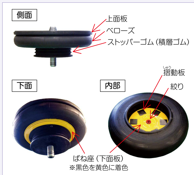
図2 空気ばね構造の一例
