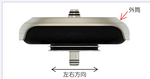
図11 異方性空気ばね(新幹線向け非線形空気ばね)
