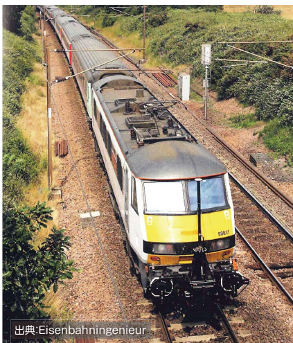
通常運行に支障なく測定データを取得するため鉄道車両に搭載されたRILAシステム
