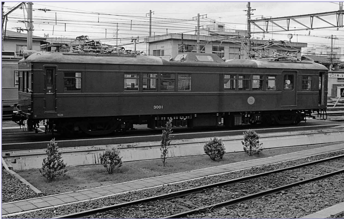
図7 東京急行電鉄の架線検測車
