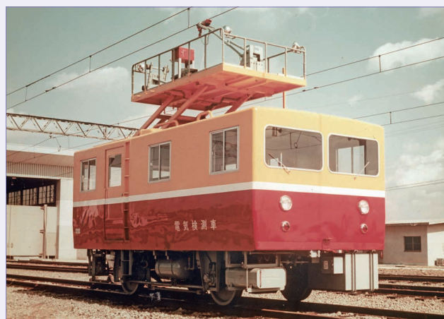
図5 近畿日本鉄道の電気検測車 提供：近鉄グループホールディングス株式会社
