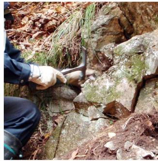
図2 ハンマーを用いた浮き石調査
