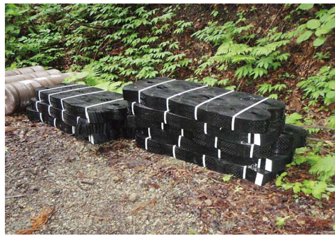
図6 折りたたんだ状態のジオセル
