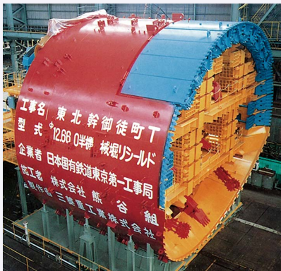
図5 半機械掘り式シールドの例
