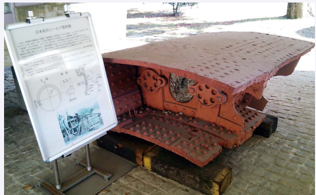
図4 折渡トンネルのシールドの一部
