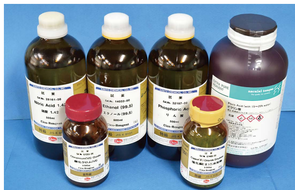
図2 金属組織を観察するための化学試薬の一例
