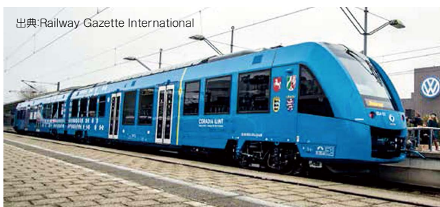
最高速度は140km/hで1000km走行可能なCoradia iLint燃料電池車両
