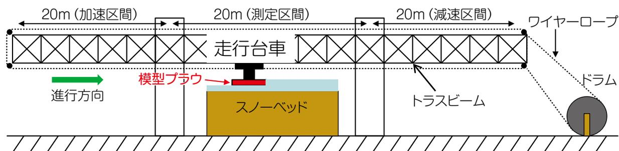
図1 排雪力測定試験装置の全体概要図
