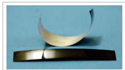
(a) 剥離事例
