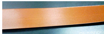
図7 ポリイミド電着したY系超電導線材
