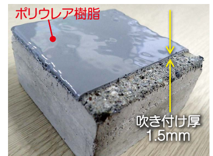
図6 樹脂により被覆された状況(模型)
