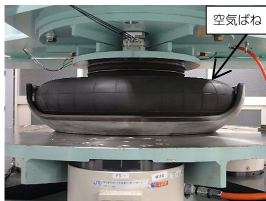
図2 試験装置に空気ばねを取り付けた例
