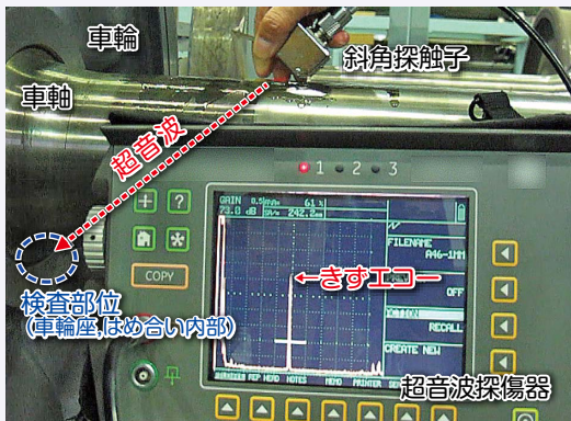
図5 斜角探傷法による車軸の超音波探傷
