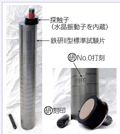
図7 標準試験片㊦No.0と水晶探触子
