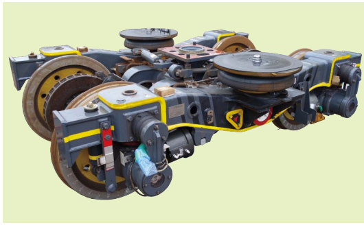
図2 脱線しにくい台車
