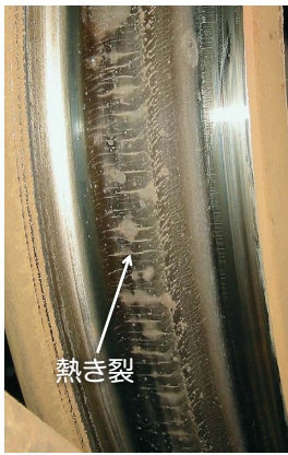
図8 車輪踏面熱き裂の例
