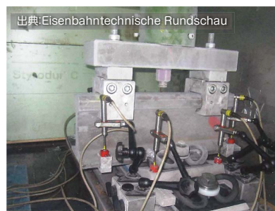
出典: Eisenbahntechnische Rundschau -20℃におけるアップリフト荷重による支承弾性の測定
