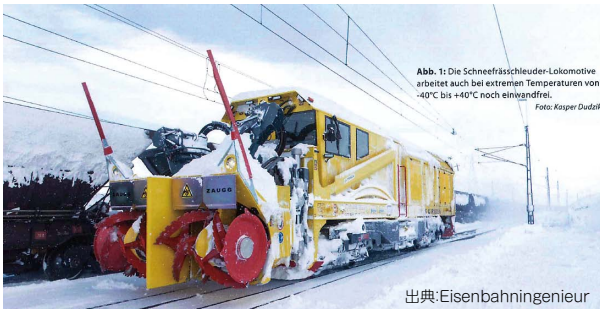
出典: Eisenbahningenieur -40℃~+40℃の温度でも問題なく運転できる除雪機関車
