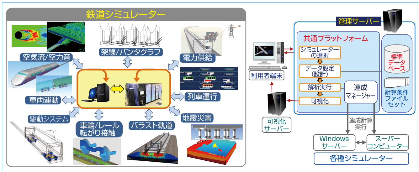
図5 鉄道シミュレーターの機能(左)と連成計算を実行するためのプラットフォーム
